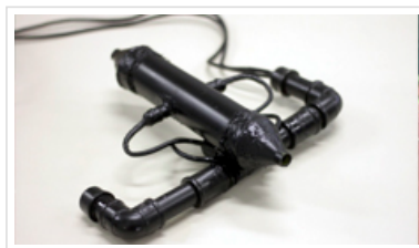
Sensor tem tubos de PVC, emissor infravermelho, receptor e placa Arduino
